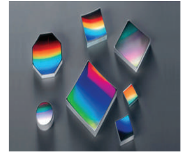
■ الشكل 11-6 تستخدم محزوزات الحيود لتكوين أنماط الحيود من أجل تحليل مصادر الضوء.
